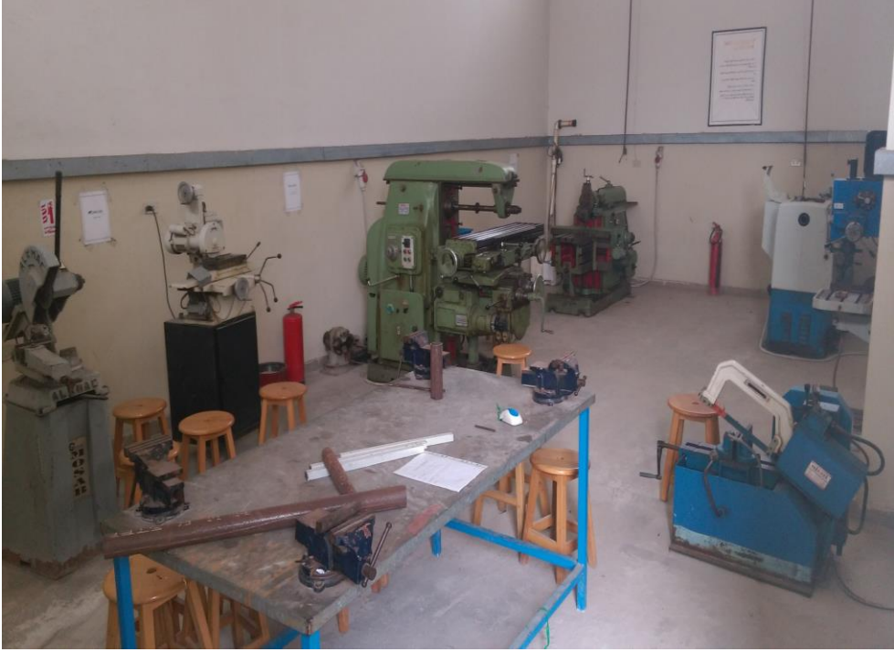
ورشة الماكينات: ماكينة خراطة - فريزة - مقشطة - مثقاب - حجر جليخ
