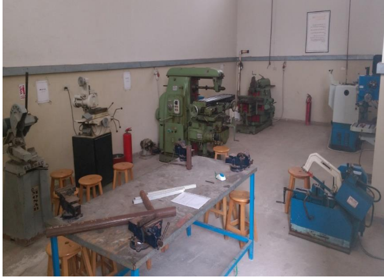
ورشة الماكينات : ماكينة خراطة - فريزة - مقطشة - مثقاب - حجر جليخ
